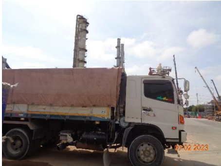
ภาพที่ 2.2-3 การปิดคลุมกระบะรถบรรทุก
