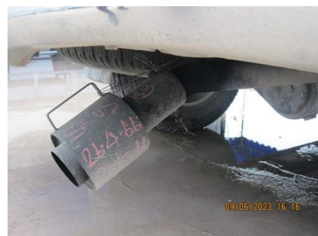
ภาพที่ 2.2-34 รถยนต์ของบริษัทผู้รับเหมาได้ติดตั้งอุปกรณ์ป้องกันประกายไฟ
