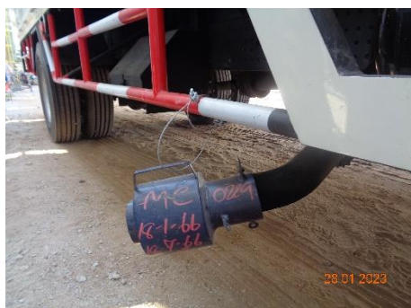
ภาพที่ 2.2-34 รถยนต์ของบริษัทผู้รับเหมาได้ติดตั้งอุปกรณ์ป้องกันประกายไฟ
